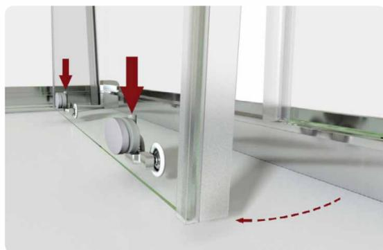
Desmontaje rodamiento tándem • Serie Descubrimiento • DETALLE
